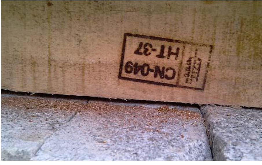
Abb. 5 Bild von trotz Stempel befallener Holzverpackung aus China
