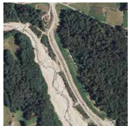
Ausweitung des Flussbettes durch Hochwasser und Errichtung eines Schutzdammes (Giswil OW, 1980/1993/2006)
